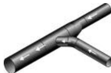
Slika 11. Montirati obrnute redukcije u smjeru proticanja ispred t-komada .
