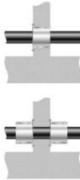
Slika 93. Montaža protupožarnih manžeta kroz zidove.
