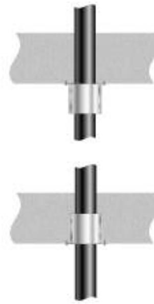
Slika 92. Montaža protupožarnih manžeta kroz stropove.
