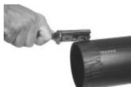
Slika 55. Ostrugati kraj cijevi ručnim strugačem.
